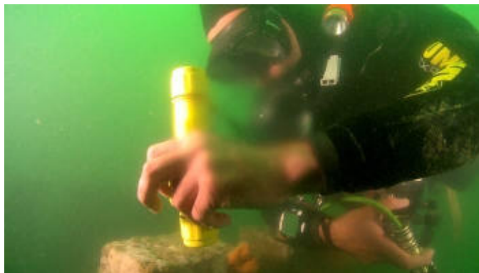
Figure 6 : Prise de mesure au sondeur acoustique.
