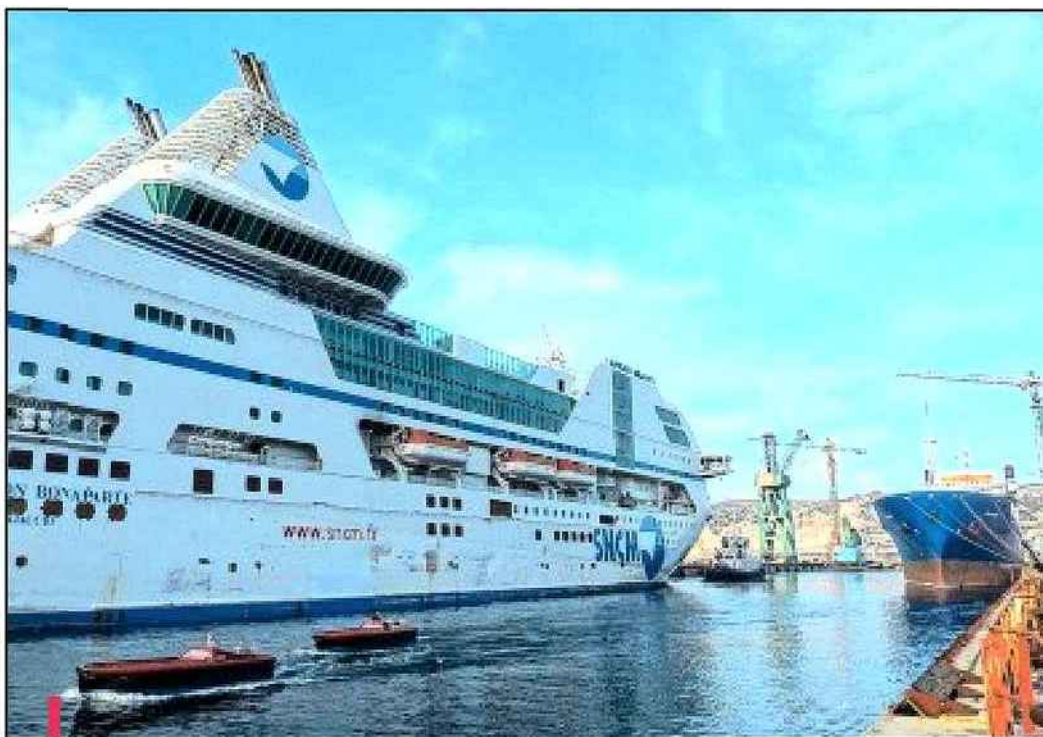
Pris en remorque, le navire-amiral de la SNCM fait son entrée dans l'immense forme 10. On distingue au droit du logo rouge www.sncm.fr , la brèche entièrement réparée et repeinte. /PHOTO PH G
